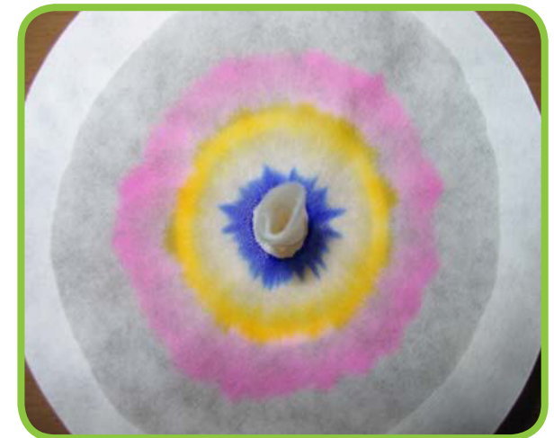
Ergebnis der Chromatographie eines schwarzen Filzstiftes
